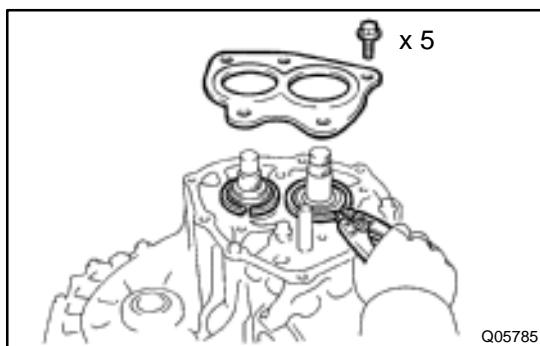
**16. REMOVE REAR BEARING RETAINER**
