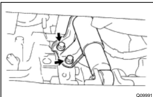
**18. DISCONNECT FRONT ENGINE ABSORBER FROM TRANSAXLE**
