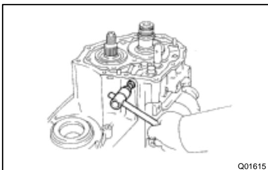
**17. REMOVE STRAIGHT SCREW PLUG, SEAT, SPRING AND LOCKING BALL**
