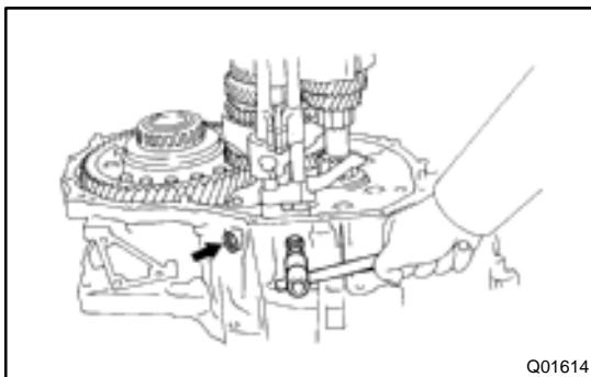
**25. REMOVE STRAIGHT SCREW PLUG, LOCKING BALL AND SPRING**
