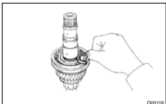
**5. INSTALL SPACER, SYNCHRONIZER RING, NEEDLE ROLLER BEARING, 4TH GEAR AND REAR BALL BEARING**
