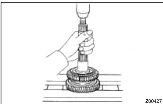
**5. REMOVE NO.1 HUB SLEEVE ASSEMBLY, 1ST GEAR, SYNCHRONIZER RING, NEEDLE ROLLER BEARING, THRUST WASHER AND LOCKING BALL**
