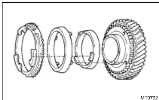
**5. INSTALL SPACER, NEEDLE ROLLER BEARING, SYNCHRONIZER RING, 2ND GEAR AND 3RD DRIVEN GEAR**
