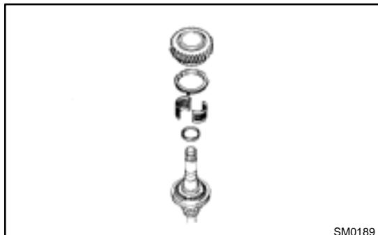
**5. INSTALL SYNCHRONIZER RING, NEEDLE ROLLER BEARING, SPACER, 4TH GEAR AND REAR BALL BEARING**
