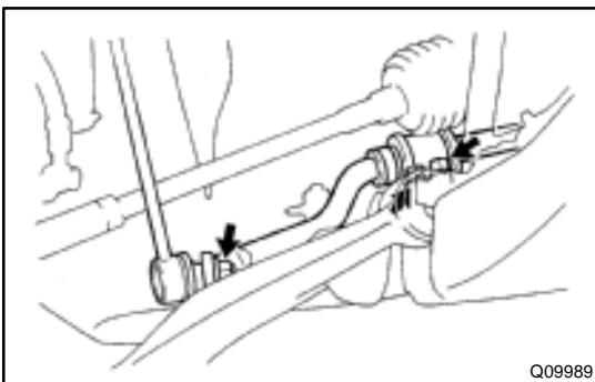
**17. DISCONNECT PS GEAR ASSEMBLY FROM FRONT SUSPENSION MEMBER**
