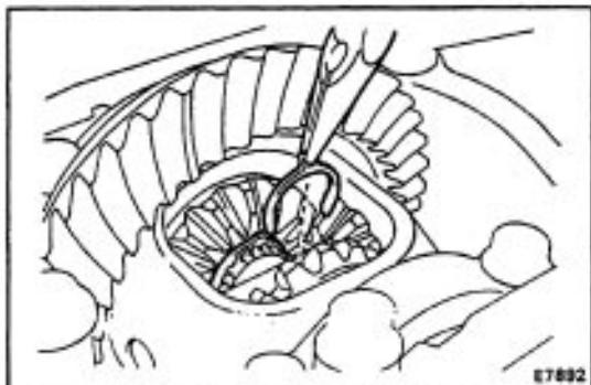
**26. INSTALL SIDE GEAR SHAFTS**
