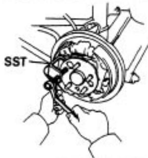
**1. REMOVE BRAKE DRUM****2. REMOVE HUB BOLT**
