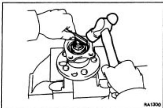
(d) Using a hammer and a chisel, stake the nut.
