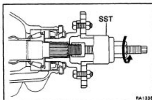
(d) Using SST, remove the companion flange.
