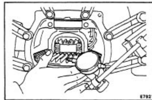
(d) Using a torque meter, measure the preload.
